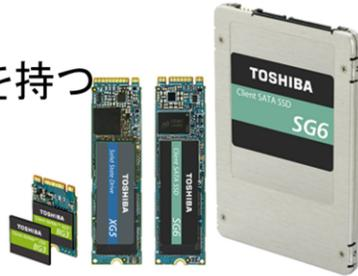
NAND型のフラッシュメモリのうちの大容量なものを使って作ったコンピュータ用の記憶装置をSSDと呼び次のページのHDD (Hard Disk Drive)と区別します。SSDはHDDに比べて小型でカード状になっており、高速です。PCやサーバーに接続して補助記憶として使います。HDDに従来から用いられたATAやSCSIのバスに接続するものと、PCIeに直接接続するもの、拡張用のバスNVMeを使うものがあります。
