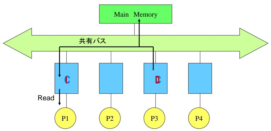
P1が読み出すとミスが起き、 主記憶に共有バスを通して取りに行く Cleanになる 共有バス上のアドレスを見て、アドレスが 一致してDのブロックへの読み出し要求を 検出→共有メモリに書き戻してからデータを 要求元に転送→Cleanになる
